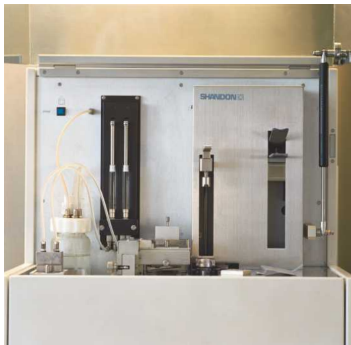
4. ... und im Eindecklerautomaten zwischen zwei Glasplatten versiegelt.
